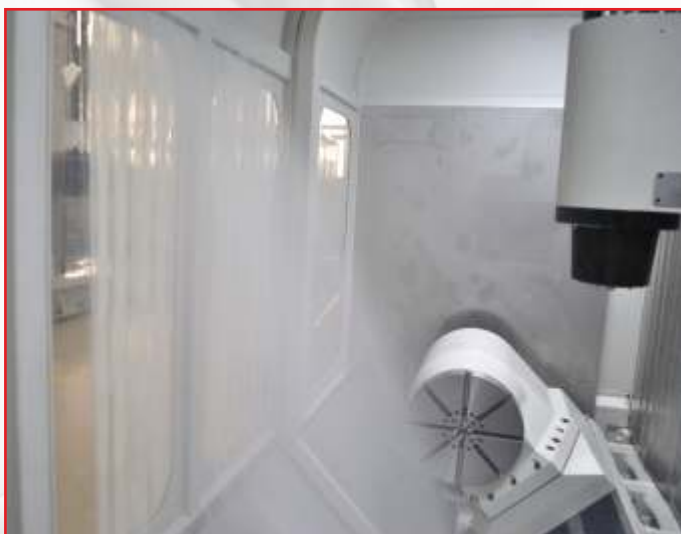
Sistema di lavaggio finestre. Washing system of windows. System von Fenster Wäsche. Système de lavage fenêtres.
