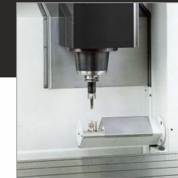
Presetting per verifica lunghezza e raggio utensile Tool preset for tool length and radius Werkzeug-Vermessung für Länge und Winkel Contrôle outil pour la longueur et le rayon
