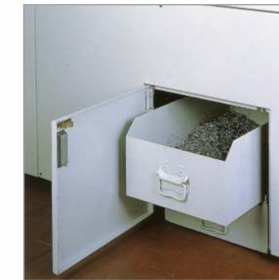
Vasche laterali per recupero trucioli Side chips and coolant tank Seitliche Späne Bacs latéraux pour recuperation copeaux
