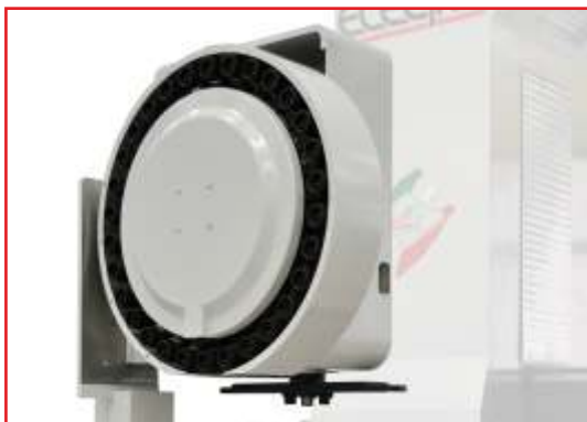
Magazzino a tamburo con braccio di scambio fissato lateralmente al basamento della macchina.
