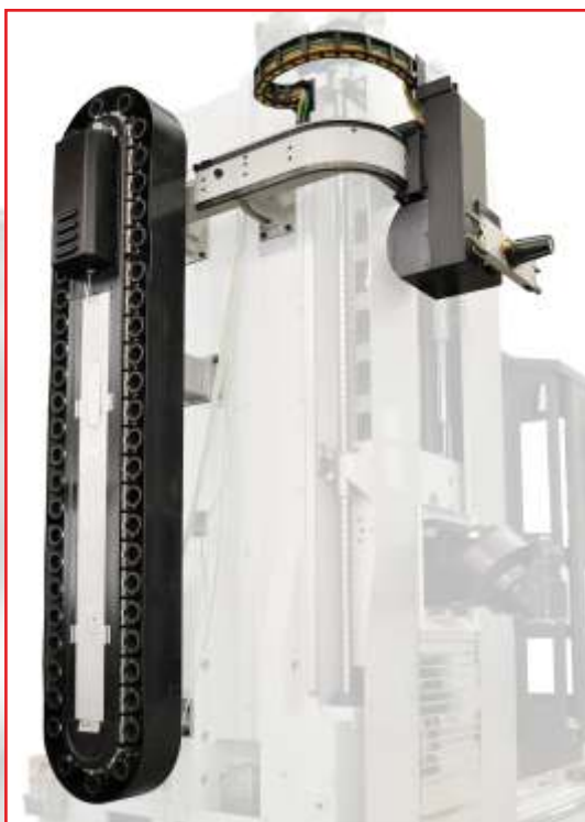
Magazzino a catena con navetta e braccio di scambio fissato lateralmente al montante della macchina.
