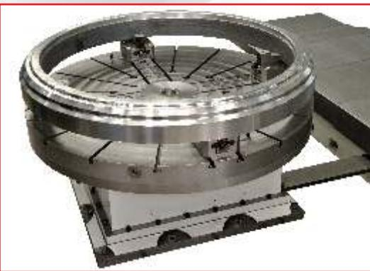
**Tavola girevole con motore digitale per tornitura e fresatura, comandata da un asse del CN.**
