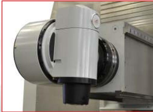
Testa a 2 assi continui di lavoro azionata da motori **torque**. Completamente raffreddata con campo di velocità del motomandrino fino a 22000 g/1'
