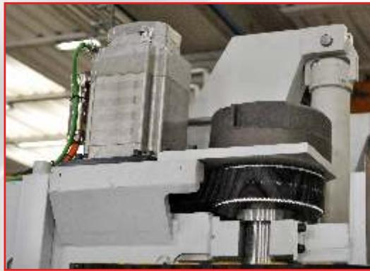
**Movimento verticale ottenuto tramite due gruppi indipendenti composti da motore, cinghia, vite a ricircolo di sfere e trasduttore di posizionamento (Gantry)**
