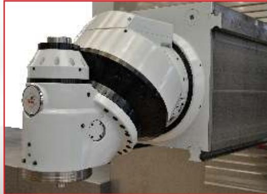
Testa a 2 assi di nuova concezione azionata da motori **torque** con posizionamento continuo e contemporaneo ( $0,001^\circ$ ) per ridurre al minimo i tempi del ciclo di lavoro. Completamente raffreddata con campo di velocità del mandrino fino a 7000 g/1'
