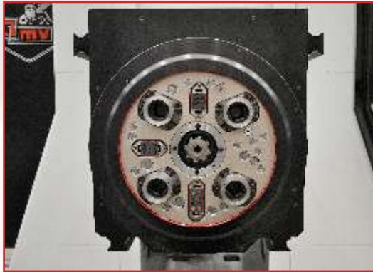
**Sistema di sbloccaggio automatico teste integrato nello slittone con pinze di trazione a funzionamento idromeccanico e corone hirth per assicurare ripetibilità di posizionamento e massima rigidità, completo di connessioni elettriche ed idrauliche. Il tutto viene gestito da CN con funzioni ausiliarie.**
